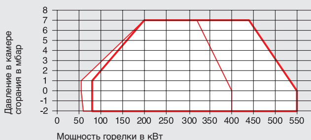
Тип горелки WG40N/1-A, исп. ZM-LN Мощность, кВт 55—550
